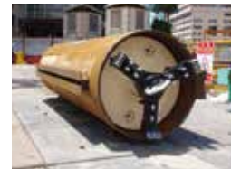
密閉型リターン回収掘進機 (外郭φ812mm残置鋼管挿入時)
