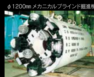
φ1200mm メカニカルブラインド掘進機
