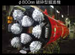
φ800mm 破碎型掘進機
