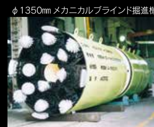
φ1350mm メカニカルブラインド掘進機
