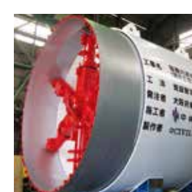
既設管直接切削接合時: リングカッタ伸長
