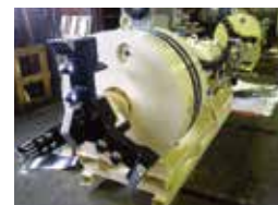
密閉型リターン回収掘進機 (一体型内部駆動装置)
