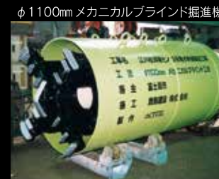
φ1100mm メカニカルブラインド掘進機
