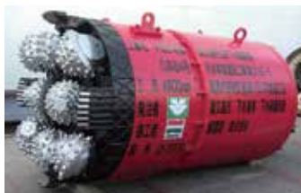
使用した破碎型掘進機
