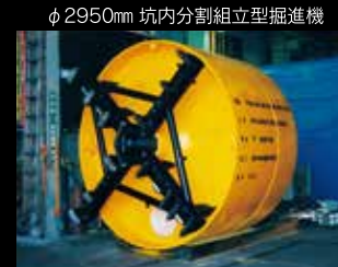
φ2950mm 坑内分割組立型掘進機
