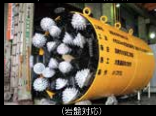
φ1500mm 破碎型掘進機
