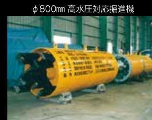
φ800mm 高水圧対応掘進機
