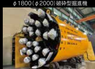
φ1800(φ2000) 破碎型掘進機
