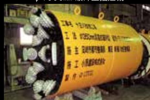
φ1000mm 破碎型掘進機
